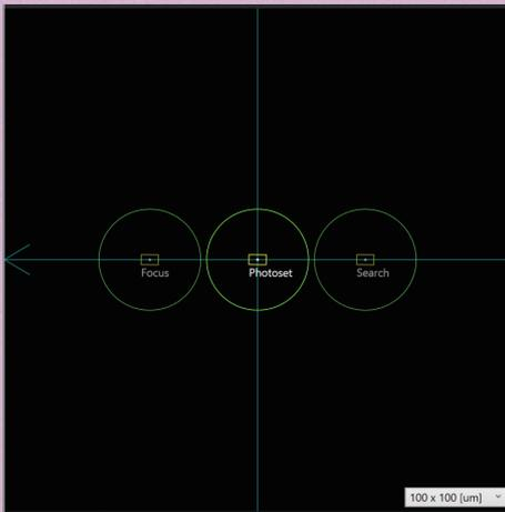
また、視野と電子線の照射範囲をグラフィカルに設定し、連続傾斜像の撮影を行うソフトウェア Recorder と連携することで低線量電子線トモグラフィを行えます。
